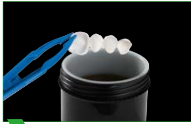
2 Погрузите каркас с помощью неметаллического пинцета в красящую жидкость ...
