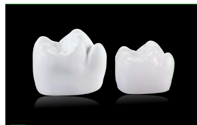
3 Моляр до и после спекания; Усадка при спекании ок. 20 процентов
