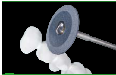
8 Предварительная полировка с помощью резинового полира.
