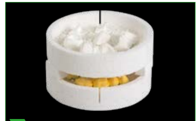
9 Одновременная синтеризация предварительно окрашенных Color/Multicolor- и вручную окрашенных реставраций.
