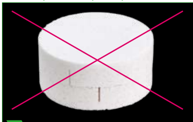
10 Без синтеризационных опор чашки друг на друга не ставить.
